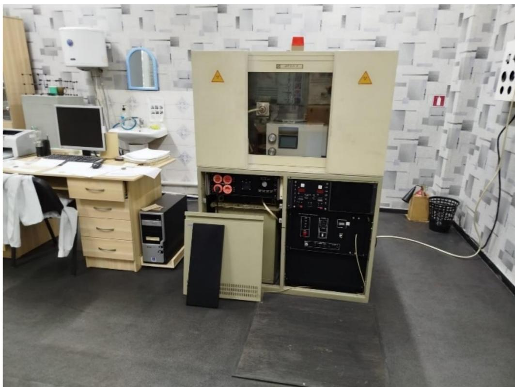
Рисунок 8 – Рентгеновский дифрактометр ДРОН-6
