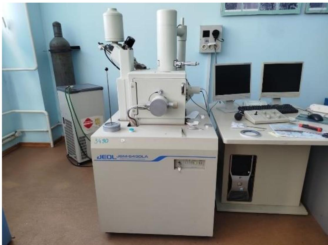
Рисунок 7 – СЭМ модели JEOL JSM – 6490LA
